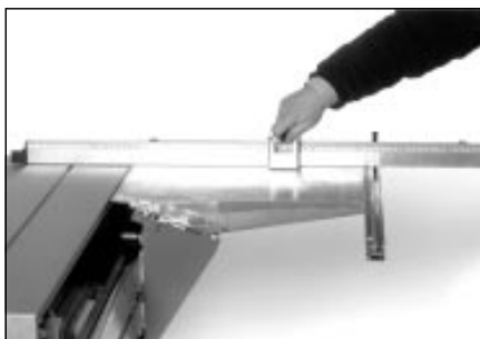
Den Reiter mittels Maßstab auf die gewünschte Formatbreite einstellen.
